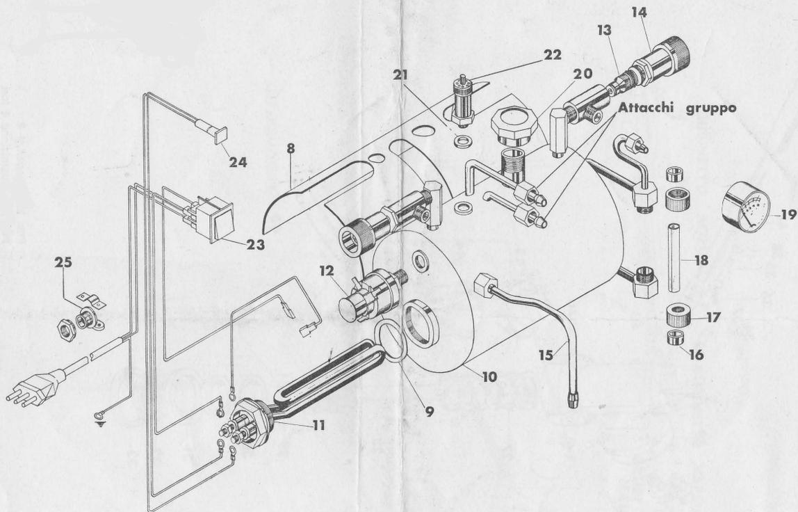
Pos. 8 Schermatura caldaia
